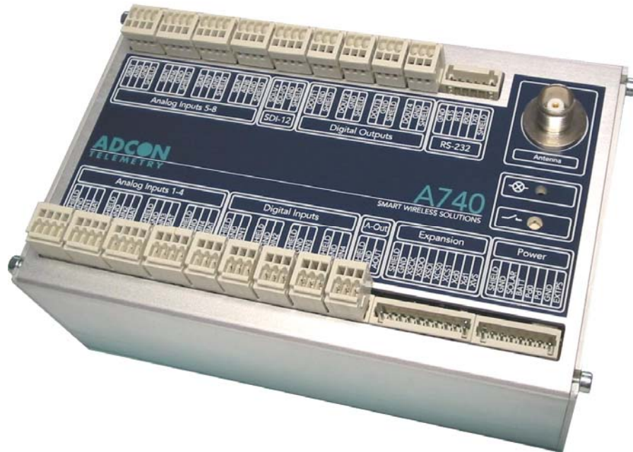
Abb. 1: RTU A740 addNODE (von vorne)
