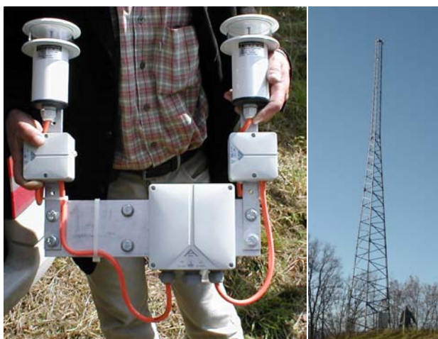
Links sieht man die Feuer mit den 2 LED's wie sie auf jedem Masten angebracht sind.
